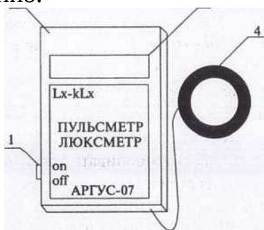
Рис. 3. Внешний вид люксметра-пульсметра «Аргус-07»
