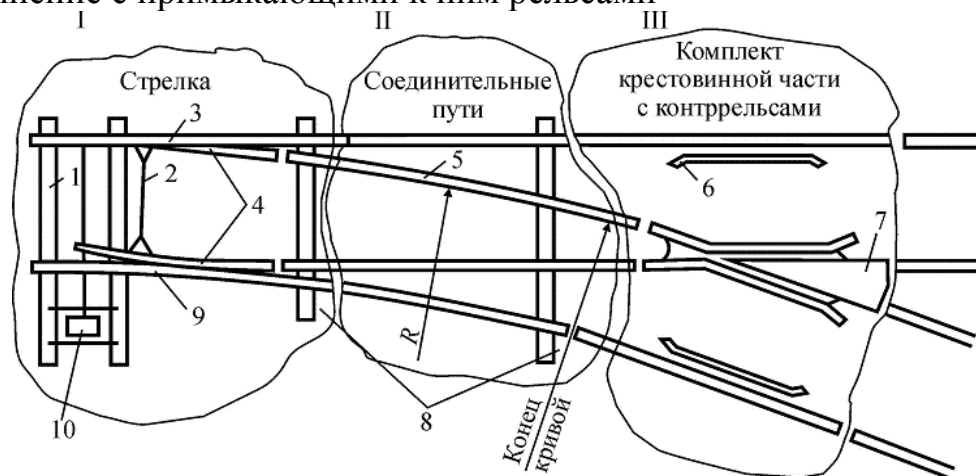
Рисунок 1 Обыкновенный одиночный стрелочный перевод
