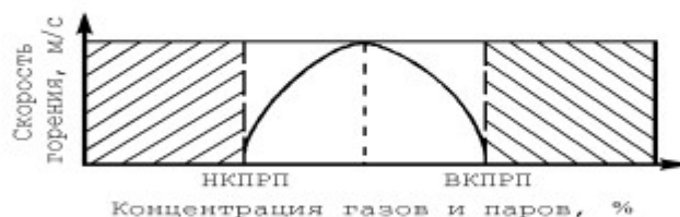
Рис. 13.1. Зависимость скорости процесса горения взрывоопасных смесей от концентрации газов и паров
