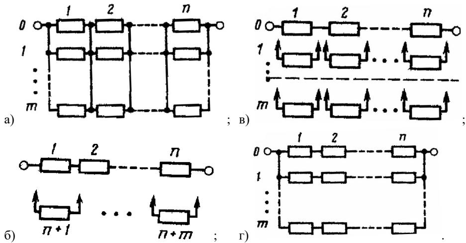
40. На каком рисунке показано раздельное резервирование замещением с дробной кратностью (скользящее резервирование)?
