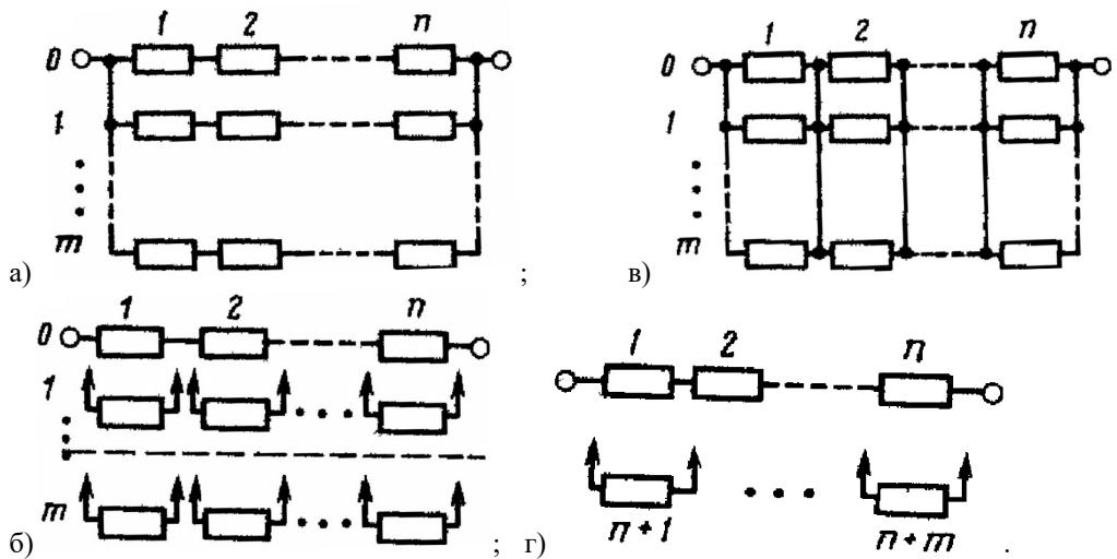
38. На каком рисунке показано раздельное резервирование с постоянно включенным резервом и с целой кратностью?
