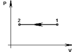
3. Найдите работу, совершающую двумя молями идеального газа при его изобарном нагревании на  $100^\circ\text{C}$  (Дж).  $R=8,3 \text{ Дж/моль}\cdot\text{К}$ :
