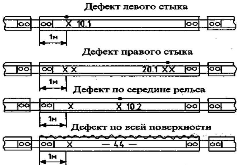
Рис 1 маркировка рельсов в пути (на перегоне)
