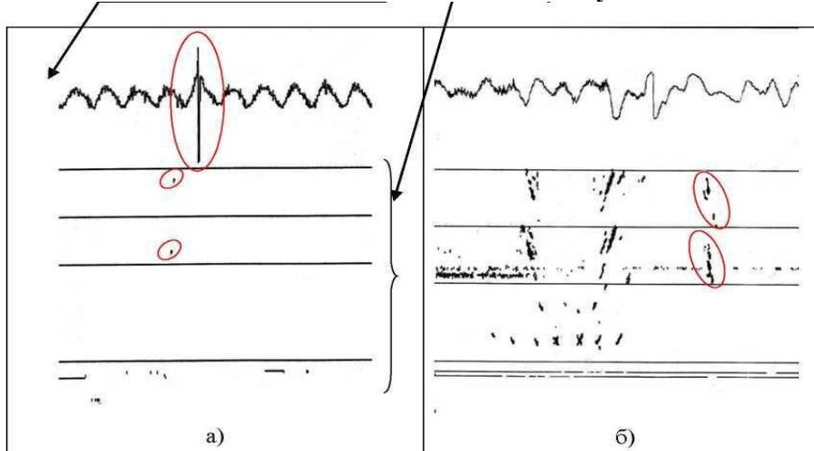
а - поперечная трещина (код 21.2) с развитием по всей головке рельса за-фиксирована
