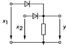
8. Определите и напишите формулу логической функции, которая реализуется схемотехническим решением
