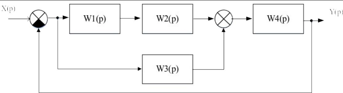
14. Произведите преобразование структурной схемы САУ и найдите ее передаточную функцию
