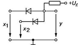
7. Определите и напишите формулу логической функции, которая реализуется схемотехническим решением
