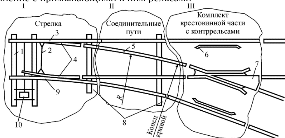
Рисунок 1 Обыкновенный одиночный стрелочный перевод
