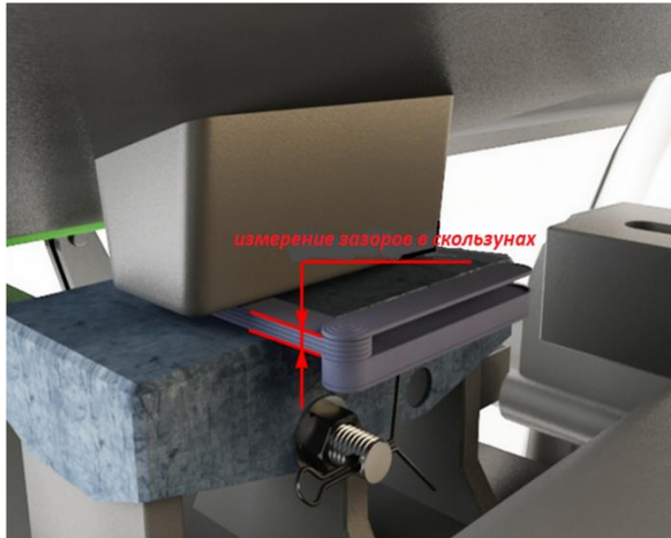
Измерение зазора между скользунами
