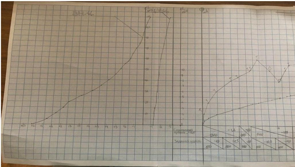
22. Определение нагрева обмоток тяговых электродвигателей.
