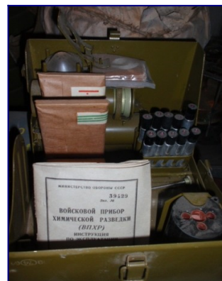
Рис. 7. Войсковой прибор химической разведки (ВПХР): 1 - ручной насос; 2 - плечевой ремень с тесьмой; 3 - насадка к насосу; 4 - защитные колпачки для насадки; 5 - противодымные
