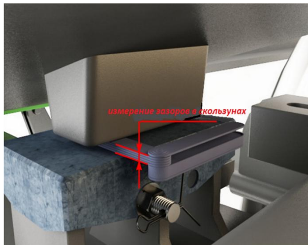
Измерение зазора между скользунами
