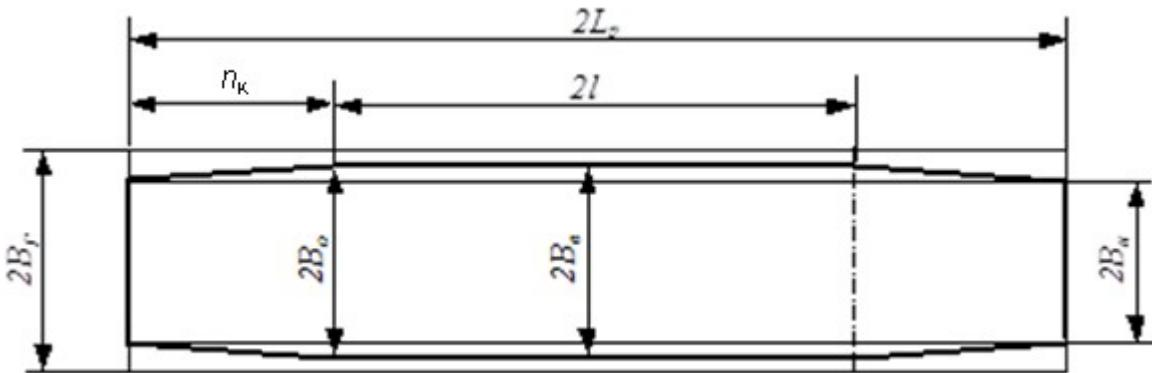
Расстояние от основного поперечного сечения до наружного (длина консольной части вагона) определяется по формуле  $n_k = \frac{2L_p - 2l}{2}$
