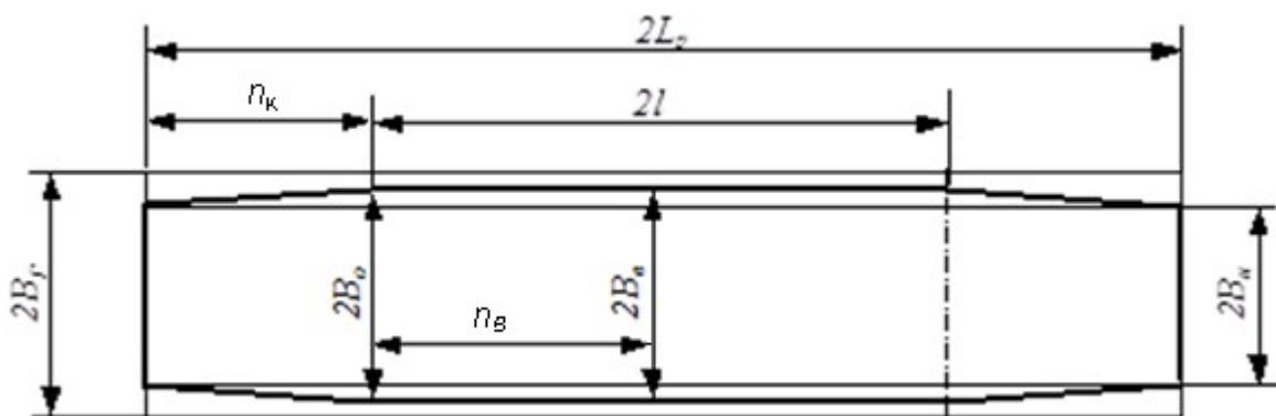
Расстояние от основного поперечного сечения до внутреннего определяется по формуле  $n_B = \frac{2l}{2}$
