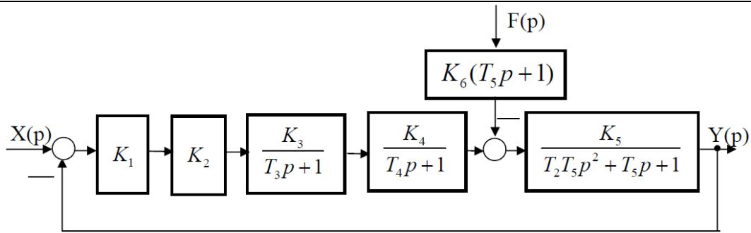
Задание №5 Преобразовать (свернуть) структурную схему САУ и получить передаточные функции замкнутой и разомкнутой САУ по управляющему и возмущающему воздействиям, а также общую передаточную функцию.
