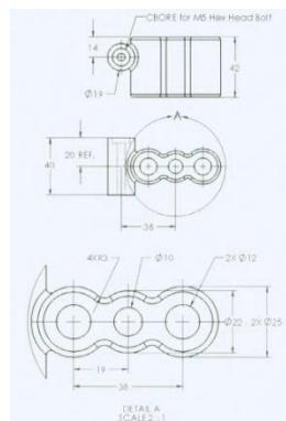
3.5. Откройте файл Задача 3 и завершите создание детали, используя следующее графическое изображение, которое соответствует замыслу проекта. Для создания детали используйте инструмент линейный массив.
