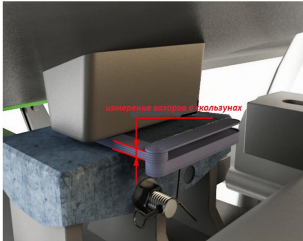
Измерение зазора между скользунами
