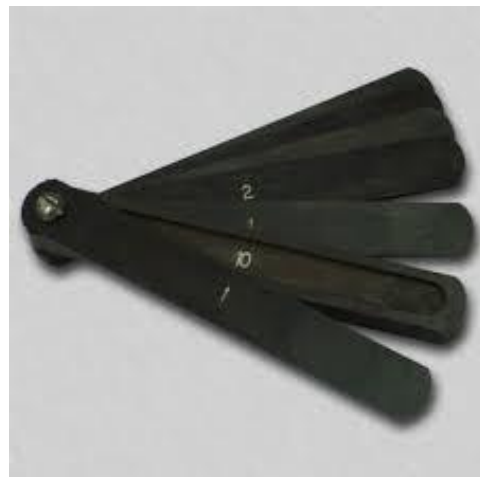
Набор щупов для измерения зазоров
