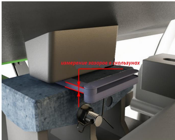
Измерение зазора между скользунами
