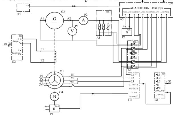
Задание 5. Схема собрана, выполнить опыт синхронизации СГ с сетью ручным способом
