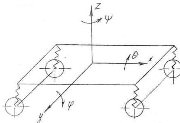
Определить угловые колебания кузова (или тележки) вагона, которые совершаются вокруг оси  $Z$ .
