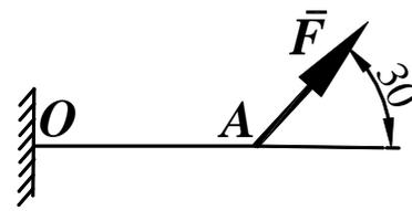
Стержень ОА, находится в вертикальной плоскости, шарнирно закреплен в точке О. Определить модуль горизонтальной силы  $\vec{F}$  (Н), при которой стержень находится в равновесии, если угол  $\alpha = 45^\circ$ , вес стержня  $G = 5$ Н приложен посредине стержня  $OC=CA$ .
