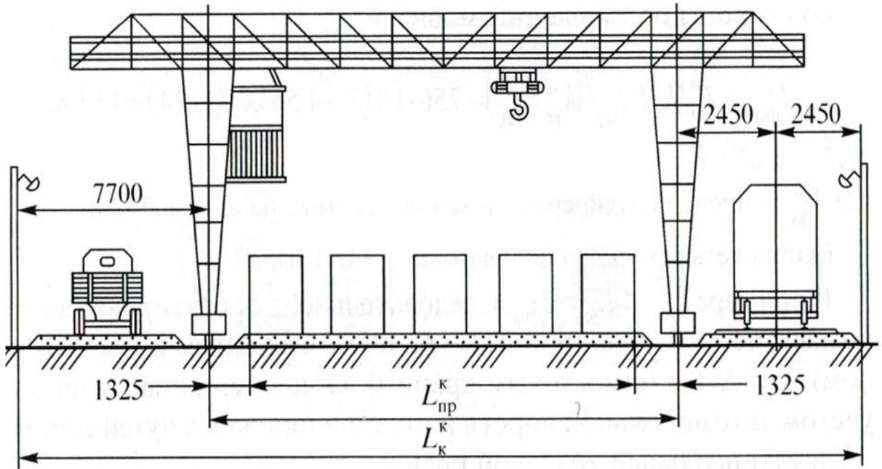
Рисунок 11.1 - Схема механизации переработки контейнеров
