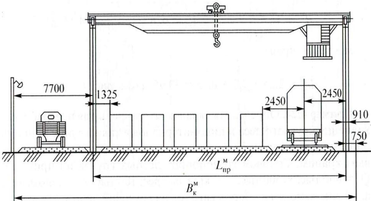
Рисунок 12.1 - Схема механизации переработки контейнеров
