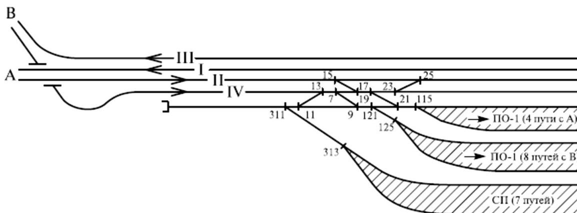
Рис. 22.1. Исходная схема горловины узловой участковой станции
