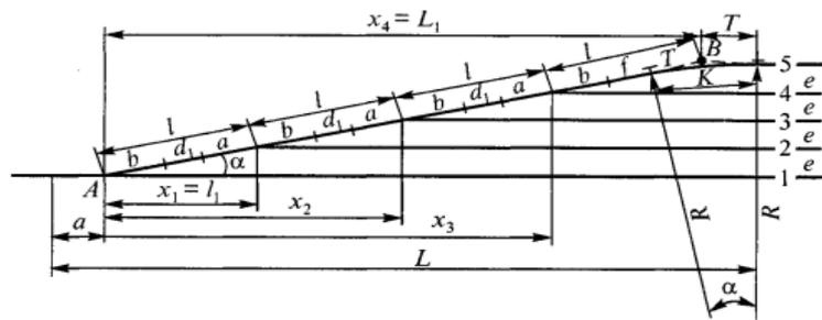
Рисунок 4.1 –Схема простейшей стрелочной улицы под углом крестовины
