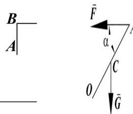
Найти длину балки  $AO$ , если при действии на нее силы  $F=800\text{Н}$  под углом  $\alpha=30^\circ$  к горизонтали момент в заделке  $O$  равен  $200\text{Нм}$ .
