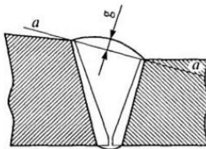
Рисунок 3 - Измерение выпуклости (вогнутости) стыкового шва ( g ) при различном уровне наружных поверхностей деталей, вызванном разницей в толщинах стенок
