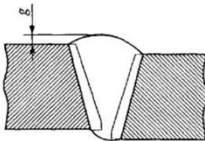
Рисунок 2 - Измерение выпуклости (вогнутости) стыкового шва ( g ) при различном уровне наружных поверхностей деталей, вызванном смещением при сборке соединения под сварку
