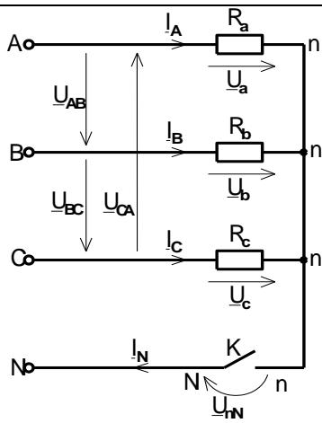
Произведите измерения фазных токов  $I_A, I_B, I_C$ ; фазных напряжений приёмника  $U_a, U_b, U_c$  и системы линейных напряжений  $U_{AB}, U_{BC}, U_{CA}$ .
