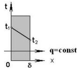
7. Если  $\lambda_1 = 50 \text{ Вт/(м·К)}$ ,  $\lambda_2 = 30 \text{ Вт/(м·К)}$ , то плотность теплового потока  $q$  в  $\text{кВт/м}^2$  равна ...
