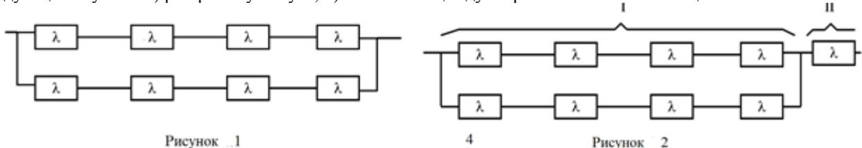
**Задача 2.** Для изображенной на рисунке 1. логической схемы системы определить  $P_c(t)$ ,  $m_{tc}$ ,  $f_c(t)$ ,  $X_c(t)$ . Здесь резерв нагруженный, отказы независимы.
