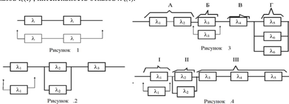
**Задача 2.** Схема расчета надежности изделия приведена на рисунке 2. Необходимо определить вероятность безотказной работы  $P_c(t)$ , частоту отказов  $f_c(t)$ , интенсивность отказов  $\lambda_c(t)$  изделия. Найти  $\lambda_c(t)$  при  $t = 0$ .
