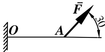
2.3 Стержень ОА, находится в вертикальной плоскости, шарнирно закреплен в точке О. Определить модуль горизонтальной силы  $\vec{F}$  (Н), при которой стержень находится в равновесии, если угол  $\alpha = 45^0$ , вес стержня  $G = 5H$  приложен посередине стержня ОС=СА.
