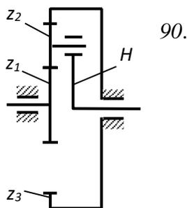
Определить передаточное отношение механизма при:  $z_1 = 15$ ;  $z_2 = 37$ ;  $z_3 =$
