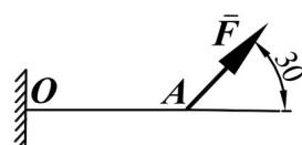
Стержень ОА, находится в вертикальной плоскости, шарнирно закреплен в точке О. Определить модуль горизонтальной силы ( $H$ ), при которой стержень находится в равновесии, если угол  $\alpha=45^0$ , вес стержня  $G=5H$  приложен посередине стержня ОС=СА.
