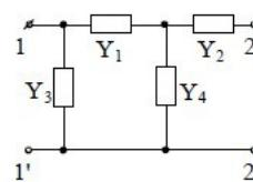
5. Определите элементы матриц  $Z$  и передачи  $A$  для реактивного входного четырехполюсника, изображенного на схеме
