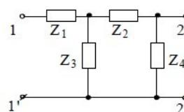
6. Определить матрицу передаточного сопротивления рельсовой цепи в контрольном режиме в соответствии со схемой с использованием математических пакетов (программного обеспечения):
