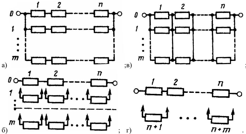
38. На каком рисунке показано раздельное резервирование с постоянно включенным резервом и с целой кратностью?
