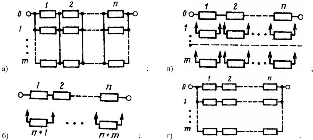
40. На каком рисунке показано раздельное резервирование замещением с дробной кратностью (скользящее резервирование)?
