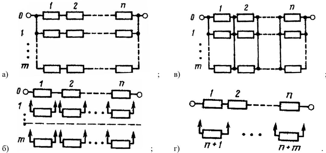
38. На каком рисунке показано раздельное резервирование с постоянно включенным резервом и с целой кратностью?
