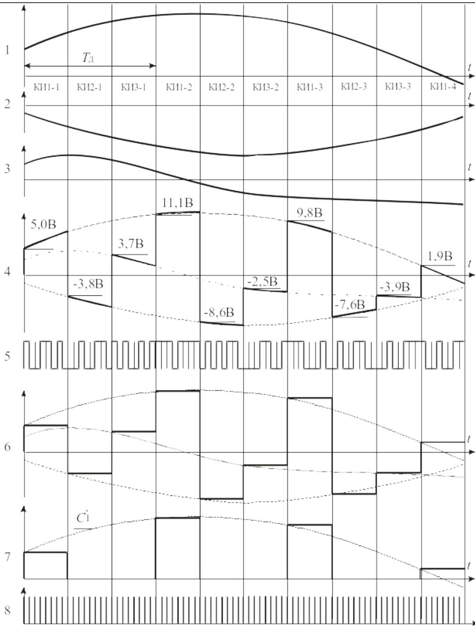
5. Дана схема и временная диаграмма трехканальной системы ВРК ИКМ. На временной диаграмме под номером «8» изображен сигнал:
