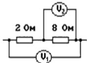
Показания первого вольтметра  $V_1$  равно 20 В. Что показывает второй вольтметр  $V_2$ ?
