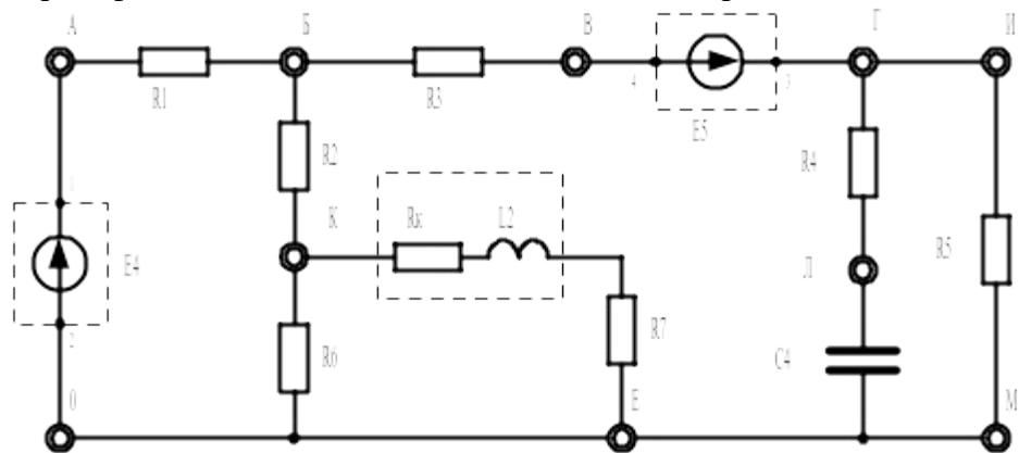
Задание 14. Используя электрическую схему, необходимо: Исследовать работу последовательной RLC-ветви в цепях синусоидального тока.
