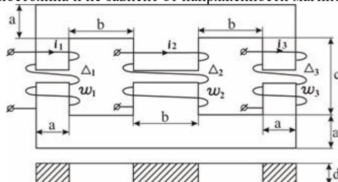
Геометрические размеры магнитопровода указаны на рисунке. Конкретный расчётный вариант, выбирается в соответствие с буквенной литературой. Конструкция включает две обмотки, по одной из которых протекает электрический ток. Один из трёх стержней магнитопровода имеет воздушный зазор. Для всех вариантов величина тока определяется по формуле:  $i = 1 + 0,1 (n/m) A$ .
