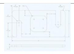
3.3. Создайте деталь, используя следующее графическое изображение, которое соответствует замыслу проекта. Отверстия концентричны круговым кромкам, созданным скруглениям. Все отверстия являются сквозными.
