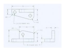
3.4. Создайте деталь, используя следующее графическое изображение, которое соответствует замыслу проекта. Радиус всех скруглений равен 2 мм, если не указано иначе.
