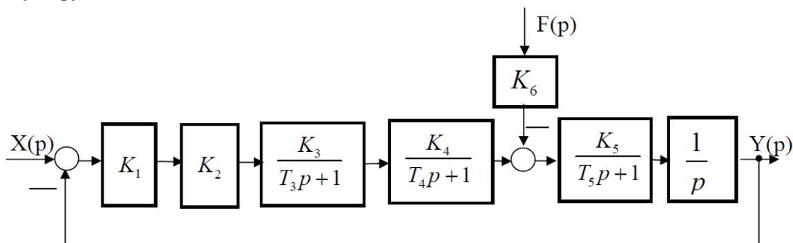
**Задание №3** Преобразовать (свернуть) структурную схему САУ и получить передаточные функции замкнутой и разомкнутой САУ по управляющему и возмущающему воздействиям, а также общую передаточную функцию.
