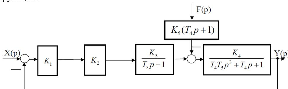
**Задание №2** Преобразовать (свернуть) структурную схему САУ и получить передаточные функции замкнутой и разомкнутой САУ по управляющему и возмущающему воздействиям, а также общую передаточную функцию.
