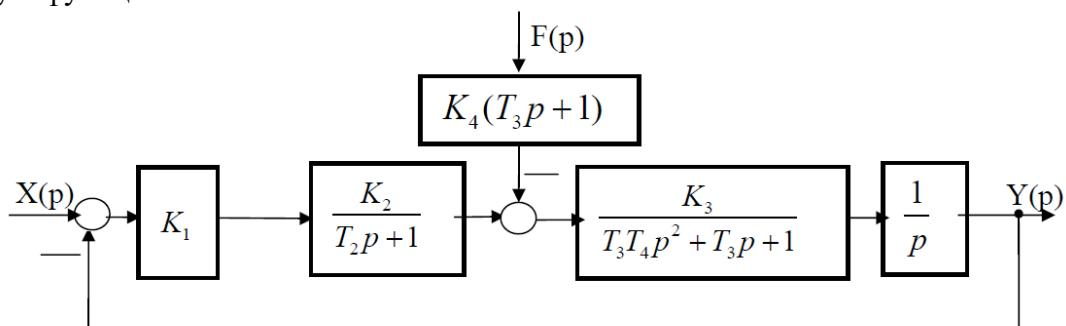
**Задание №4** Преобразовать (свернуть) структурную схему САУ и получить передаточные функции замкнутой и разомкнутой САУ по управляющему и возмущающему воздействиям, а также общую передаточную функцию.
