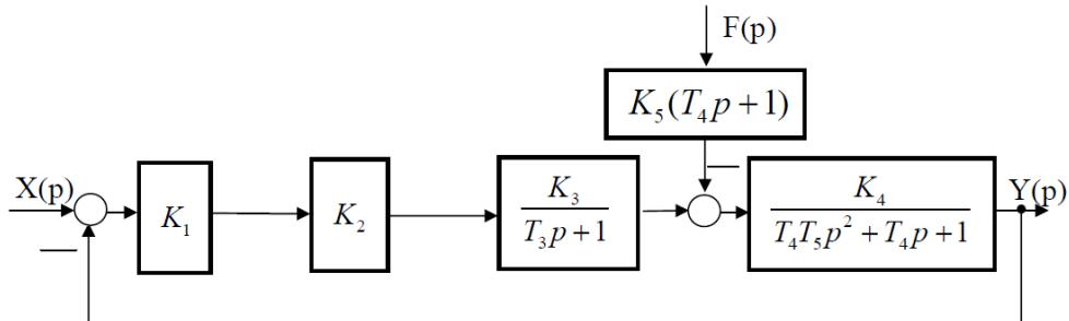
**Задание №2** Преобразовать (свернуть) структурную схему САУ и получить передаточные функции замкнутой и разомкнутой САУ по управляющему и возмущающему воздействиям, а также общую передаточную функцию.
