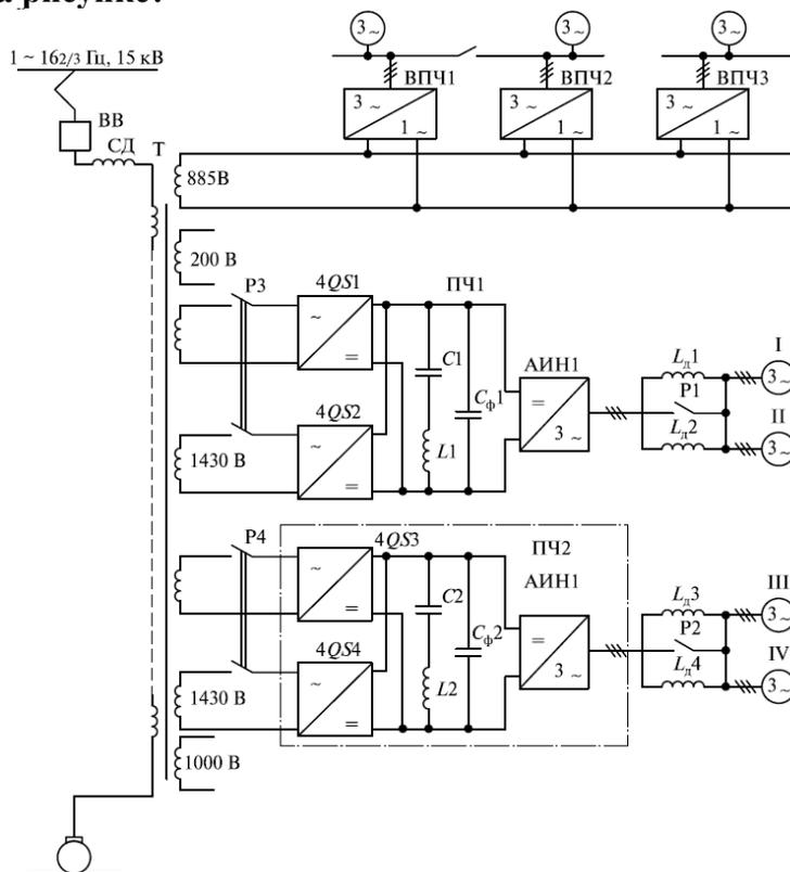
ВВ — высоковольтный выключатель; Т — тяговый трансформатор; ПЧ1, ПЧ2 — преобразователь частоты; СД — сглаживающий дроссель; P1-P4 — разъединители;
