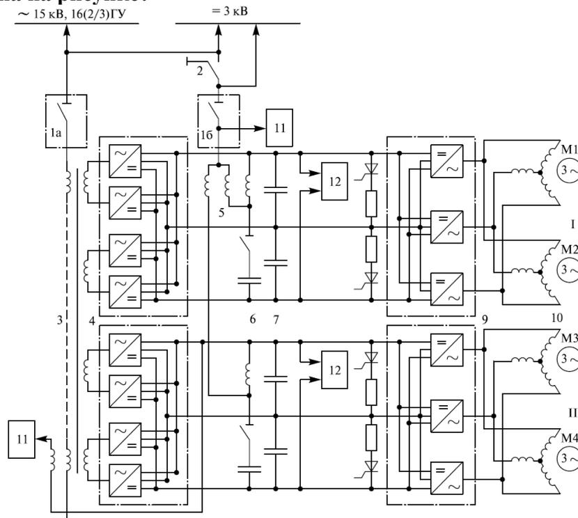
1а, 1б — главные выключатели для работы на переменном и постоянном токе; 2 — системный переключатель; 3 — тяговый (преобразовательный) трансформатор; 4 — четырехквadrантный преобразователь; 5 — входной дроссель; 6 — резонансный контур; 7 — конденсаторы фильтра; 8 — тормозные резисторы; 9 — автономные инверторы напряжения с ШИМ; 10 — АД М1-М4; 11 — система отопления поезда; 12 — автономный инвертор бортовой сети
