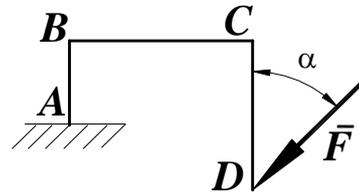
Найти длину балки АО, если при действии на нее силы  $F=800$ Н под углом  $\alpha = 30^\circ$  к горизонтали момент в заделке О равен 200Нм.
