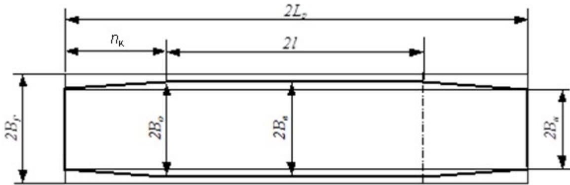
Расстояние от основного поперечного сечения до наружного (длина консольной части вагона)
