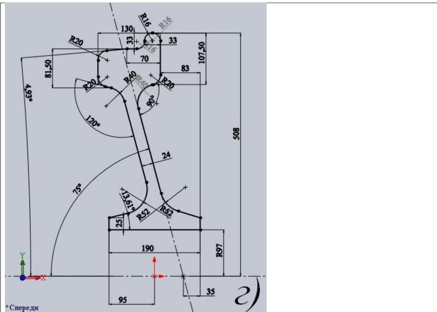
**Задание 2.** Разработать модель среднего листа цистерны в SolidWorks с параметрическим заданием размеров, используя инструмент «Уравнения» (этапы разработки модели, представленные рисунками и расположенные в произвольном порядке, прилагаются)
