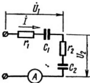
45. Для схемы, изображенной на рис. Операторным методом найти выражение мгновенных значений тока в неразветвленной части цепи и напряжения на обкладках конденсатора при замыкании рубильника  $P$ . Даны:  $U = 200$  в,  $t = 100$  ом,  $r_2 = 400$  ом и  $C = 5$  мкф.
