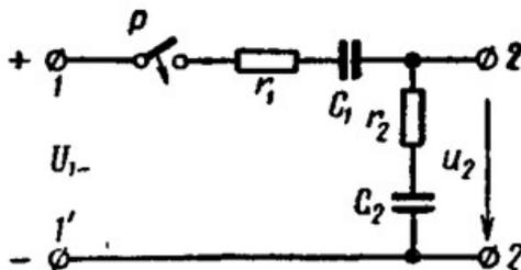
23. К цепи схемы, изображенной на рис., подключается гармоническое напряжение  $u = U_m \sin(\omega_2 t + \psi)$ . Найти закон изменения во времени тока, проходящего в неразветвленной части цепи.
