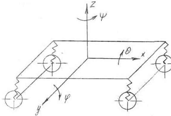
Определить поступательное линейное перемещение наддресорного строения вагона в направлении оси  $Z$ .
