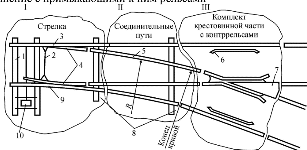
Рисунок 1 Обыкновенный одиночный стрелочный перевод
