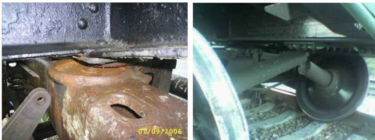
Рисунок 1.2 - Неисправности, вызванные повышенной периодической нагрузкой (фото из открытых источников)
