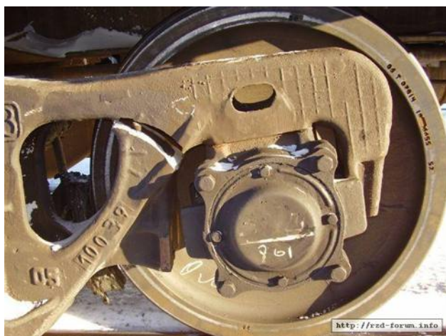
Рисунок 1.4 - Изломы боковых рам тележки (фото из открытых источников)
