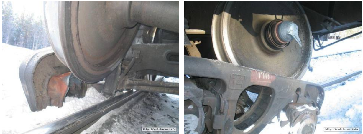
Рисунок 1.5 - Перегрев буксового узла, вызвавший излом шейки оси колесной пары (фото из открытых источников)
