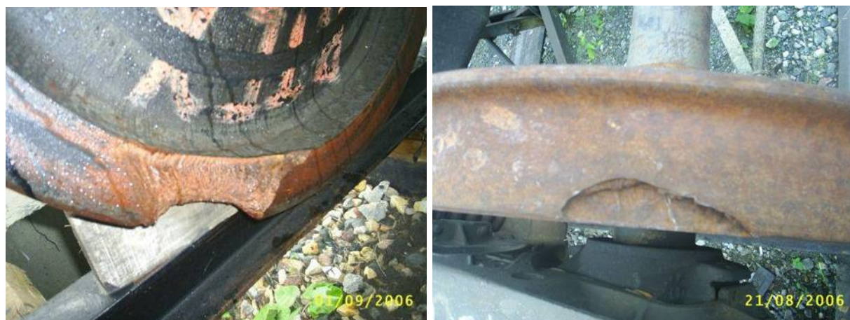
Рисунок 1.3 - «Сколы» на гребне и поверхности катания колеса (фото из открытых источников)
