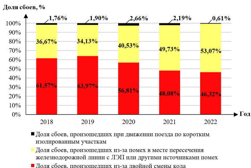
Рисунок 1.4 – Распределение доли сбоев третьей категории в работе системы АЛСН в зависимости от причин на анализируемой железной дороге за период 2018-2022 гг.
