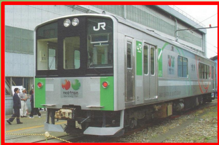
Новый японский состав NE-train на водородных топливных элементах
