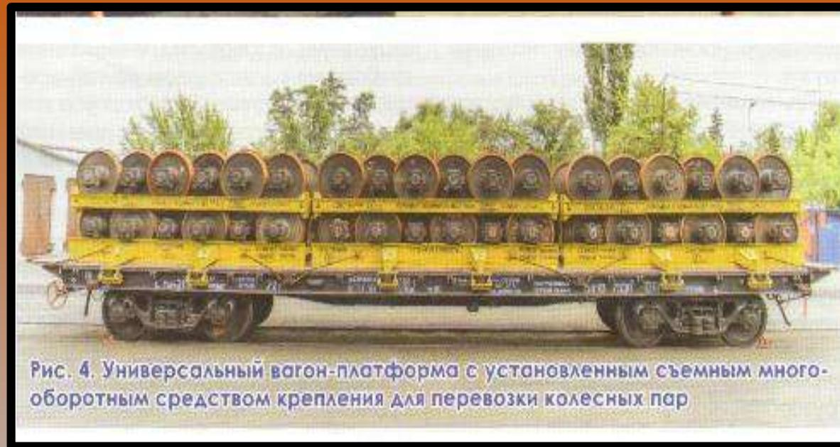
Рис. 4. Универсальный вагон-платформа с установленным съемным многооборотным средством крепления для перевозки колесных пар
