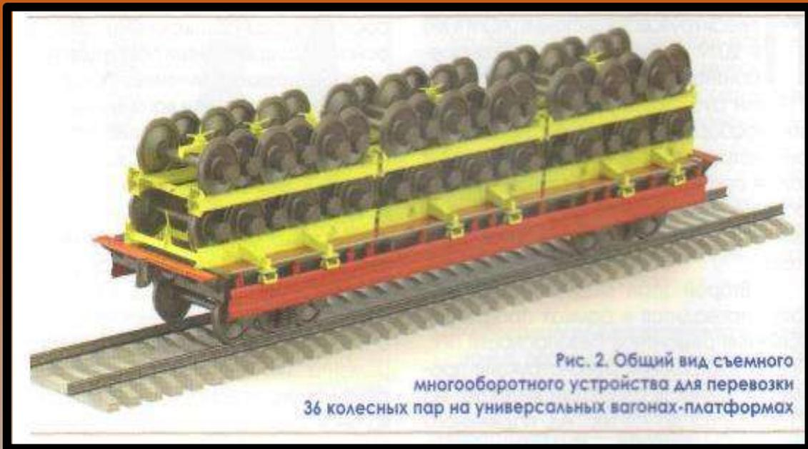
Рис. 2. Общий вид съемного многооборотного устройства для перевозки 36 колесных пар на универсальных вагонах-платформах
