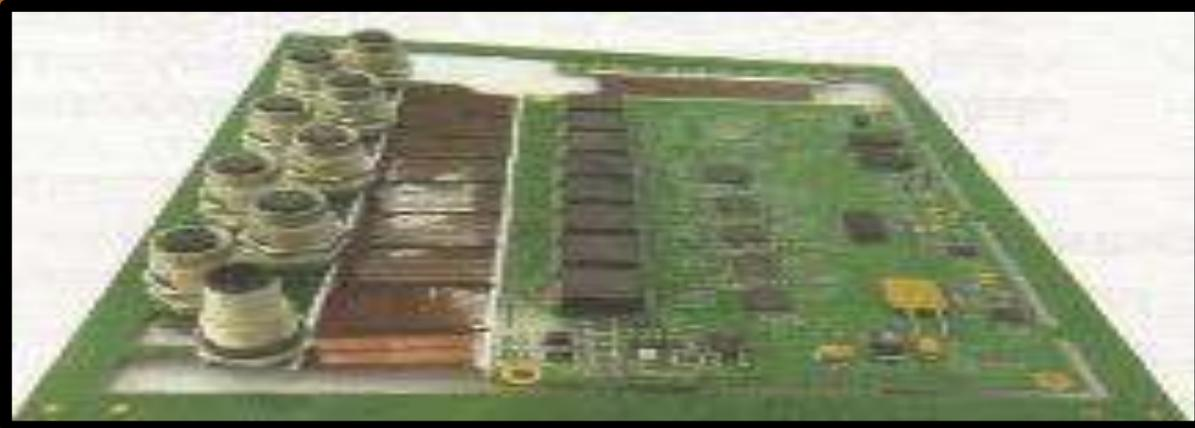
Гибко-жесткие печатные платы и соединители для поверхностного монтажа
