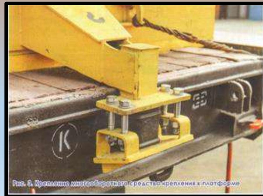
Рис. 5. Крепление многооборотного средства крепления к платформе
