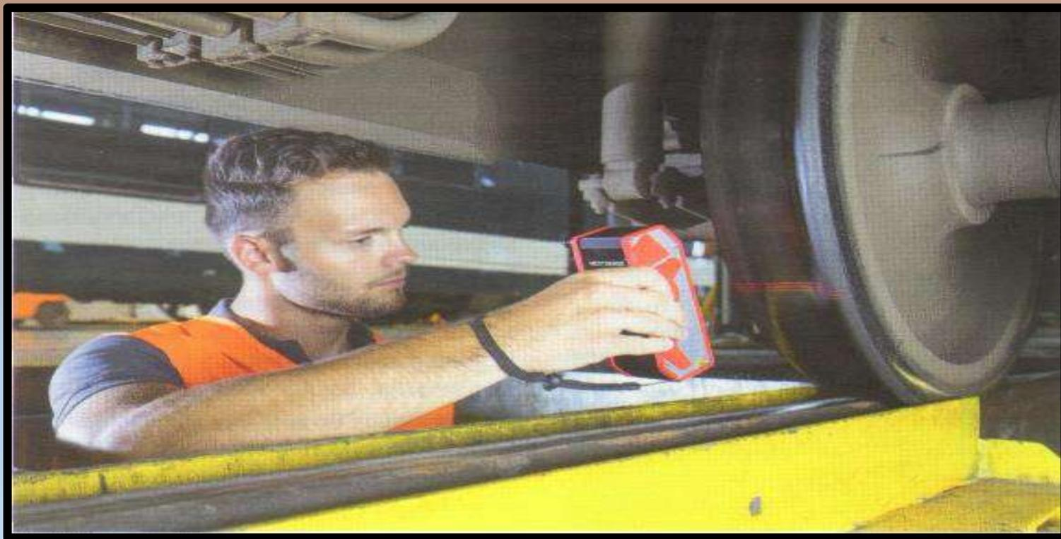
Контроль состояния колесных пар с использованием прибора Calipri Prime
