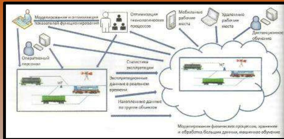
Структурная схема взаимодействия цифрового двойника с его объектом (сортировочной станцией), а также персоналом станции
